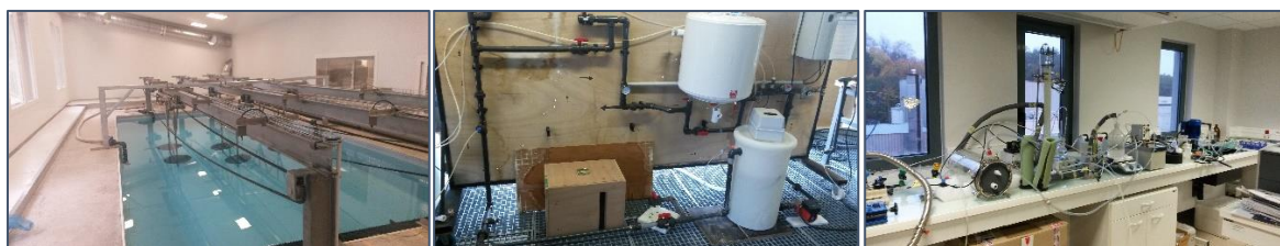
Figure 1 Bassin expérimental, pilote à échelle réduite et banc de génération de trichloramine, au C.S.T.B.
